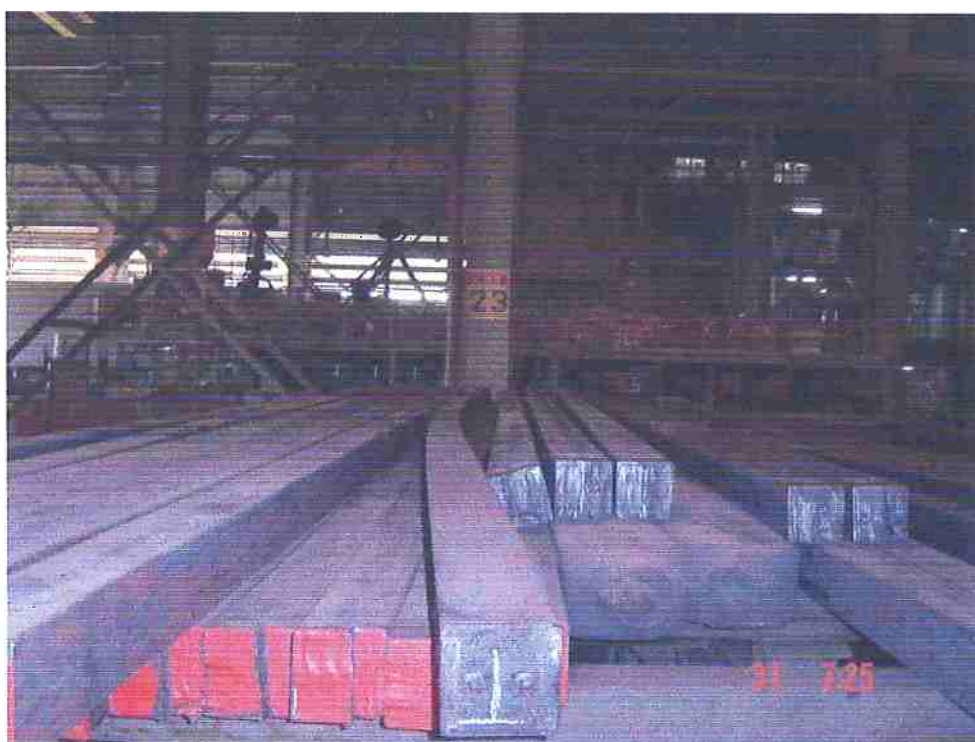
Figura 41. Foto do tarugo de aço SAE 4340 de onde foram retiradas as amostras para a metalografia.
