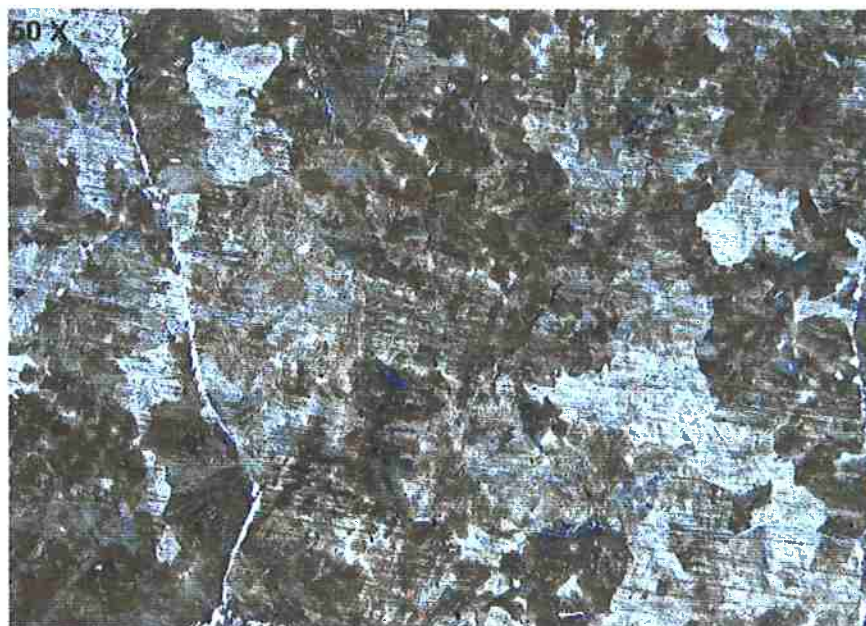
Figura 53. Micrografia obtida por microscopia ótica de uma amostra da região a meia altura da face protegida do tarugo (2). Aumento: 50x.
