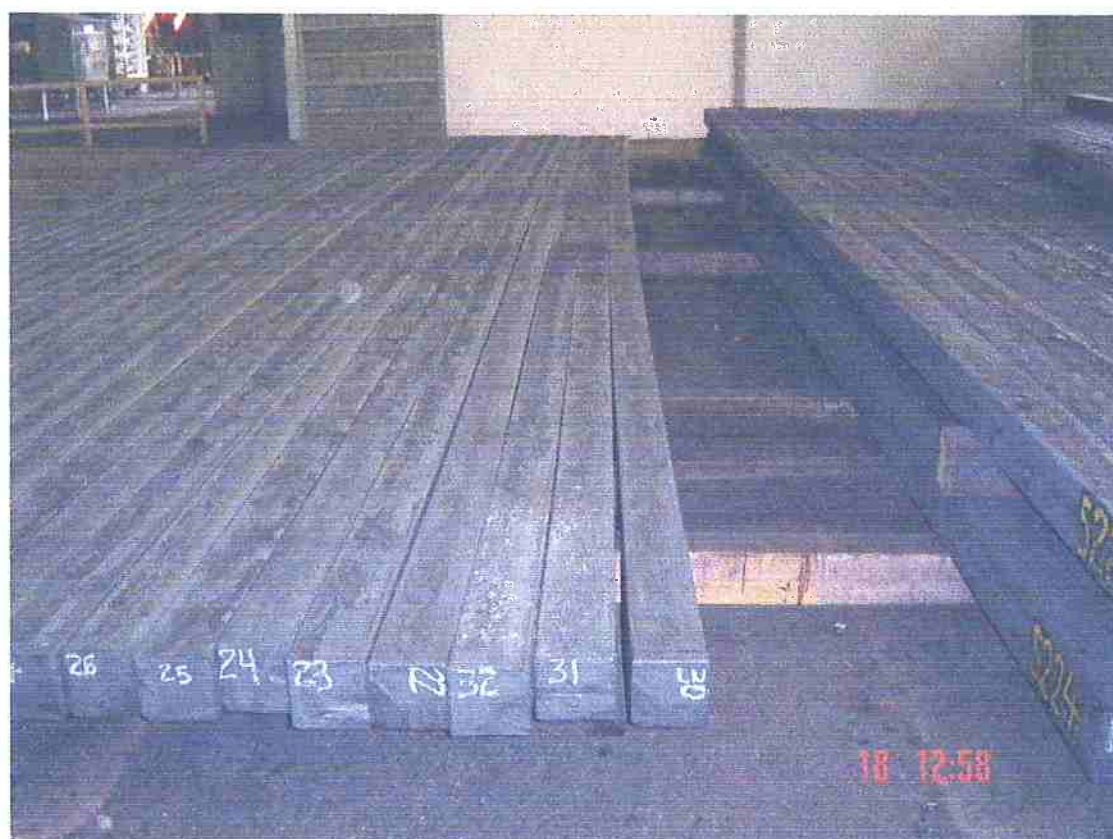
Figura 5. Tarugo empenado por efeito da contração linear decorrente do resfriamento diferencial.
