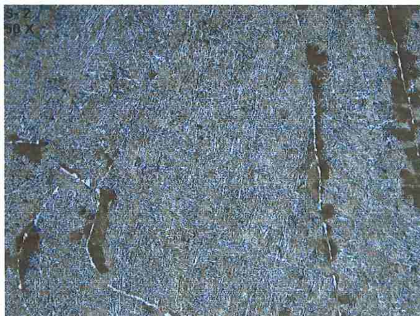
Figura 47. Micrografia obtida por microscopia ótica de uma amostra da região a meia altura da face superior do tarugo (S2). Aumento: 50x.
