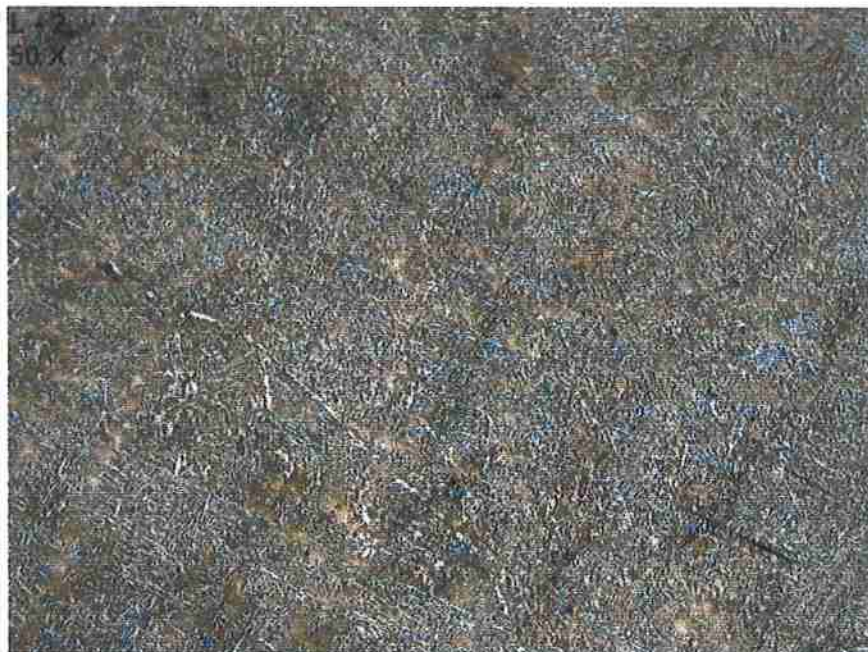
Figura 44. Micrografia obtida por microscopia óptica de uma amostra da região a meia altura da face exposta do tarugo (L2). Aumento: 50x.
