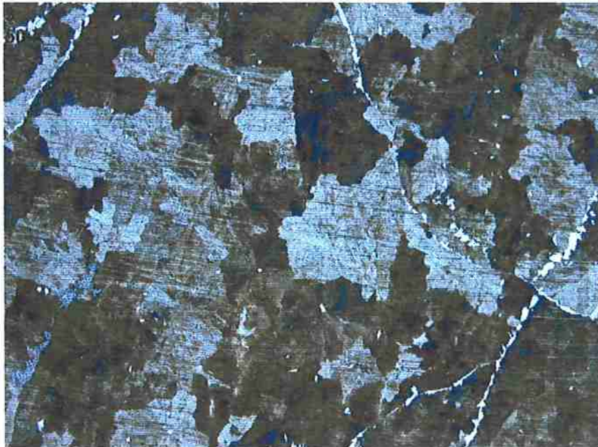
Figura 54. Micrografia obtida por microscopia ótica de uma amostra da região da face protegida do tarugo próxima ao centro da peça (3). Aumento: 50x.
