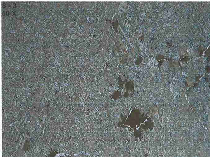
Figura 46. Micrografia obtida por microscopia ótica de uma amostra da região mais próxima à face superior do tarugo (S3). Aumento: 50x.
