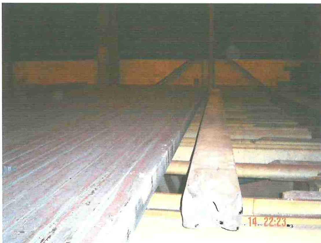
Figura 67. Tarugos de aço SAE 4140 após os teste da caixa sem empeno significativo.
