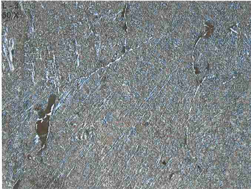
Figura 43. Micrografia obtida por microscopia óptica da região do tarugo mais exposta ao meio (L1). Aumento 50x.
